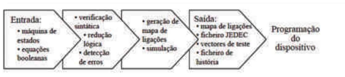
Fig. 30 - Sequência da programação em PALASM
