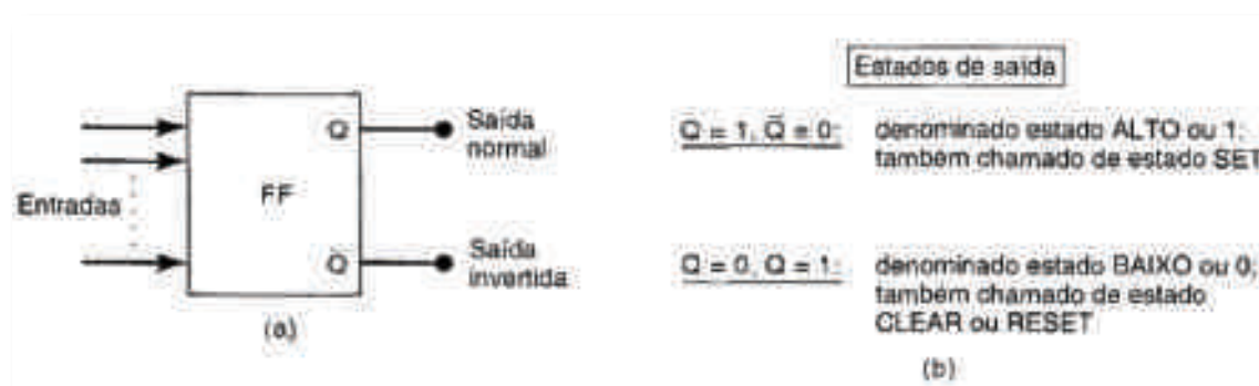
Fig. 2: Símbolo de um flip-flop genérico e definição dos dois estados de saída possíveis
