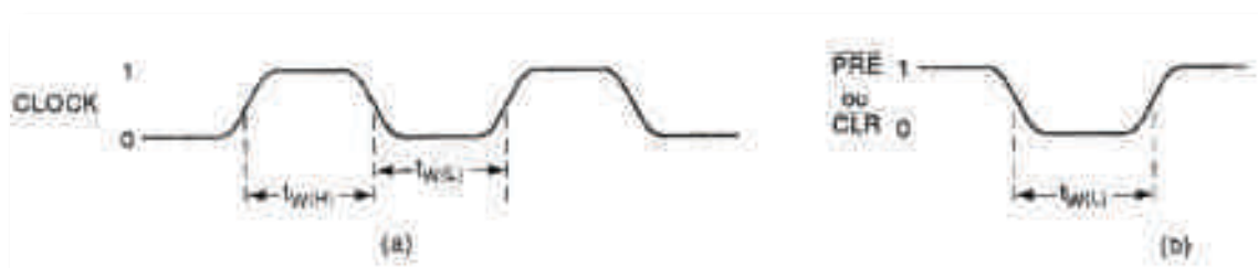
Fig. 32: (a) Tempos de duração do CLOCK em BAIXO e em ALTO; (b) largura de pulso assíncrono.
